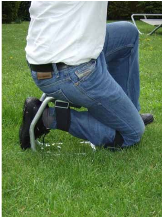
L'ergosiège, un outil pour soulager les opérations manuelles
