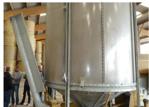
Figure 3 : Séchoir cylindrique (PIGNEROL, 2016)
